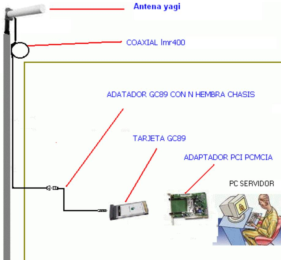
Nota: Al conectar la tarjeta al PC, el computador se puede utilizar como servidor proxy, así más de un computador se puede conectar.
